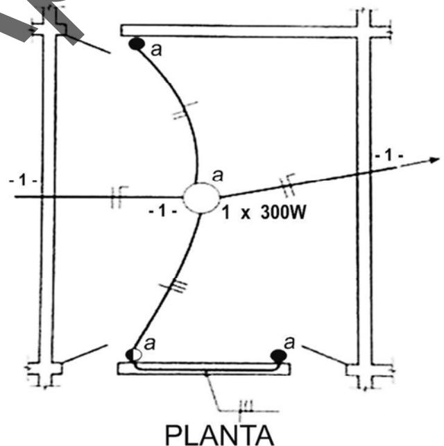
O diagrama unifilar apresentado indica o circuito de ligação de uma lâmpada com
