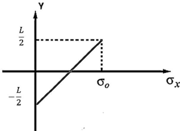
Em uma seção de barra quadrada de lado  $L$ , atuam somente tensões normais que variam conforme o gráfico apresentado. O valor do esforço normal será igual a
