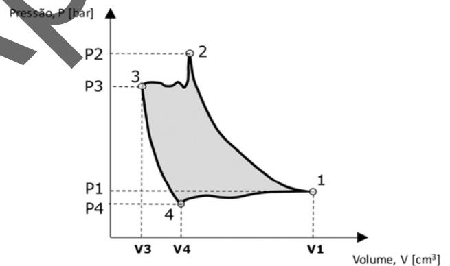
Essa figura corresponde ao diagrama pressão x volume de um compressor alternativo a pistão. Tal diagrama representa as variações reais de pressão x volume, sofridas pelo gás no interior do cilindro durante a respectiva compressão. Com base na análise desse diagrama, é correto afirmar que
