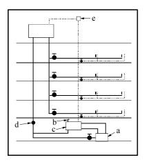
A figura acima representa esquematicamente um sistema ascendente, sem circulação, de aquecimento central de água de um edificio. Nessa figura, estão representados alguns componentes do sistema de aquecimento, incluindo caldeira, válvula de segurança contra pressão, caixa de água fria, válvula de rentenção e ventosa. Com base na disposição desses elementos na figura, é correto afirmar que o componente indicado pela letra
