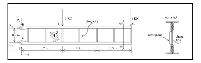
A figura acima mostra uma longarina construída a partir de quatro cantoneiras rebitadas em uma chapa fina. Entre as cantoneiras, são rebitados reforçadores feitos de chapa dobrada em Z. A longarina é fixada à fuselagem por meio de dois pinos nas posições indicadas por B e C.
